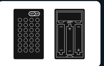
4. 请检查电池盒的电源开关是开启状态并且电池“+”“-”极放置正确（确保您使用的是新电池。）
