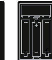
4.Prüfen Sie, ob der Netzschalter am Batteriekasten eingeschaltet ist und ob die Pole „+“ und „-“ der Batterie korrekt platziert sind (bei Verwendung neuer Batterien). Stellen Sie sicher, dass die oberen und unteren Anschlüsse an den Polen „+“ und „-“ des Netzschalters richtig installiert sind.
