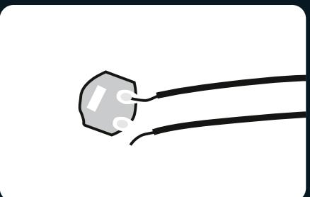
2. Controllare se i fili sono scollegati o rotti dalle saldature.
