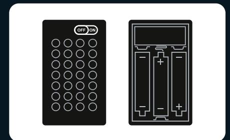
4. Vérifiez que l'interrupteur du boîtier de la batterie est en position de marche et que les pôles « + » et « - » de la batterie sont correctement placés (en utilisant des batteries neuves). Assurez-vous également que les connexions supérieures et inférieures aux pôles « + » et « - » de l'interrupteur sont correctement installées.
