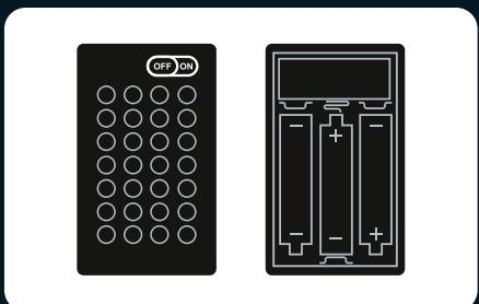
4. Verificare che l'interruttore di alimentazione sulla scatola della batteria sia acceso e che i poli "+" e "-" della batteria siano posizionati correttamente (utilizzando batterie nuove) e assicurarsi che i collegamenti superiori e inferiori ai poli "+" e "-" dell'interruttore di alimentazione siano installati correttamente.
