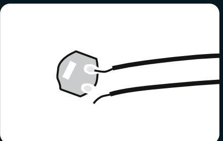
2. Compruebe si los cables están desconectados o rotos de las juntas de soldadura.
