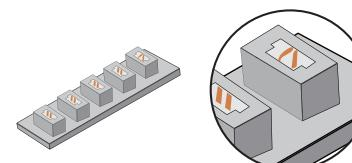
3.Überprüfen Sie die inneren Stifte der Steckerbuchsen. Die inneren Stifte eines ordnungsgemäß funktionierenden Anschlusses sollten gerade sein. Wenn die kleinen Stifte verbogen sind, können sie als fehlerhafte Anschlüsse betrachtet werden.
