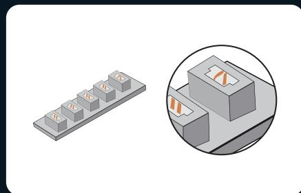
3. Vérifiez les broches internes des connecteurs. Les broches internes d'un port de connecteur fonctionnant correctement doivent être droites. Si les petites broches sont pliées, elles peuvent être considérées comme des ports défectueux.
