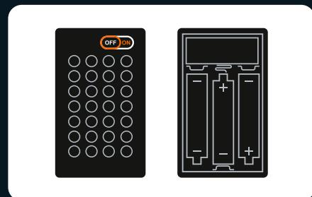
4. Vérifiez que l'interrupteur du boîtier de la batterie est en position de marche et que les pôles « + » et « - » de la batterie sont correctement placés (en utilisant des batteries neuves). Assurez-vous également que les connexions supérieures et inférieures aux pôles « + » et « - » de l'interrupteur sont correctement installées.
