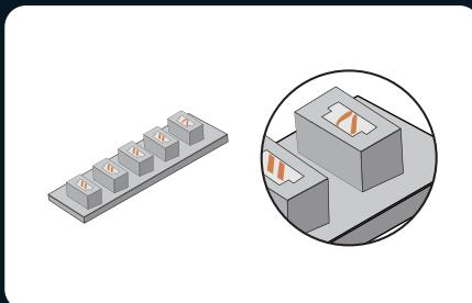
3. Überprüfen Sie die inneren Stifte der Steckerbuchsen. Die inneren Stifte eines ordnungsgemäß funktionierenden Anschlusses sollten gerade sein. Wenn die kleinen Stifte verbogen sind, können sie als fehlerhafte Anschlüsse betrachtet werden.
