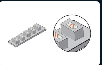
3. 请检查连接器插口的内部引脚，正常工作的连接器端口内部小引脚应该是直的，如果是弯的小引脚则可以判断为故障端口。
