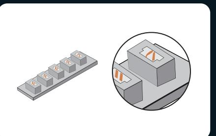
3. Controllare i pin interni delle prese dei connettori. I pin interni di una porta del connettore che funziona correttamente devono essere diritti. Se i piccoli pin sono piegati, possono essere considerati porte difettose.
