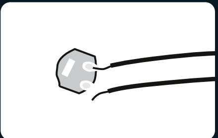
2. 请检查电线是否从焊点脱落或断裂。
