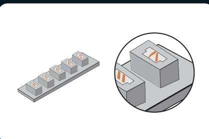
3. Vérifiez les broches internes des connecteurs. Les broches internes d'un port de connecteur fonctionnant correctement doivent être droites. Si les petites broches sont pliées, elles peuvent être considérées comme des ports défectueux.
