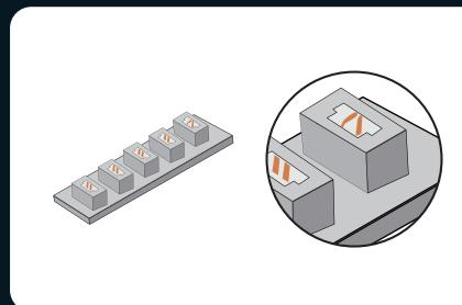
3. Compruebe las patillas internas de las tomas de los conectores. Las patillas internas de una toma de conector que funcione correctamente deben estar rectas. Si las pequeñas patillas están dobladas, pueden considerarse puertos defectuosos.
