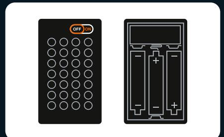
4. Prüfen Sie, ob der Netzschalter am Batteriekasten eingeschaltet ist und ob die Pole „+“ und „-“ der Batterie korrekt platziert sind (bei Verwendung neuer Batterien). Stellen Sie sicher, dass die oberen und unteren Anschlüsse an den Polen „+“ und „-“ des Netzschalters richtig installiert sind.
