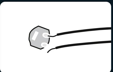
2. Vérifiez que les fils ne sont pas déconnectés ou cassés au niveau des joints de soudure.
