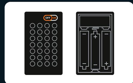
4. Compruebe que el interruptor de alimentación de la caja de la batería está encendido y que los polos «+» y «-» de la batería están colocados correctamente (utilizando baterías nuevas), y asegúrese de que las conexiones superior e inferior a los polos «+» y «-» del interruptor de alimentación están instaladas correctamente.
