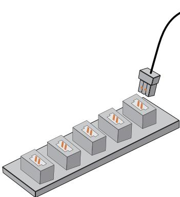
1.Asegúrese de que los conectores están correctamente instalados como se muestra en la imagen.
