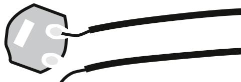
2.Compruebe si los cables están desconectados o rotos de las juntas de soldadura.
