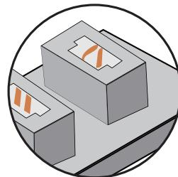
3.Compruebe las patillas internas de las tomas de los conectores. Las patillas internas de una toma de conector que funcione correctamente deben estar rectas. Si las pequeñas patillas están dobladas, pueden considerarse puertos defectuosos.
