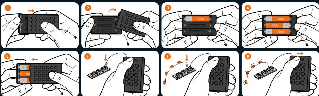
Nom du boîtier à piles: Boîtier de piles en blocs de construction n° 7   Type de piles: AAA\*3 (n° 7)   Tension nominale de la pile: 1,5 V
