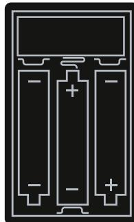
4. 请检查电池盒的电源开关是开启状态并且电池“+”“-”极放置正确（确保您使用的是新电池。）
