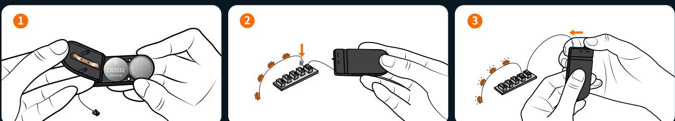
Batteriefachname: Ovales Batteriefach    Batteriemodell: CR2032\*2    Batterienennspannung: 3V
