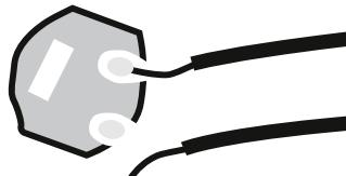
2. Vérifiez que les fils ne sont pas déconnectés ou cassés au niveau des joints de soudure.
