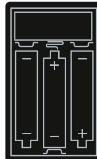
4.Compruebe que el interruptor de alimentación de la caja de la batería está encendido y que los polos «+» y «-» de la batería están colocados correctamente (utilizando baterías nuevas), y asegúrese de que las conexiones superior e inferior a los polos «+» y «-» del interruptor de alimentación están instaladas correctamente.
