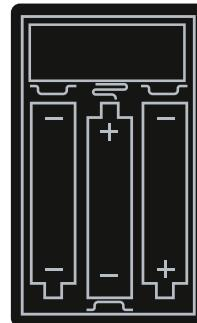
4. Verificare che l'interruttore di alimentazione sulla scatola della batteria sia acceso e che i poli "+" e "-" della batteria siano posizionati correttamente (utilizzando batterie nuove) e assicurarsi che i collegamenti superiori e inferiori ai poli "+" e "-" dell'interruttore di alimentazione siano installati correttamente.
