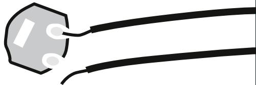
2. 请检查电线是否从焊点脱落或断裂。
